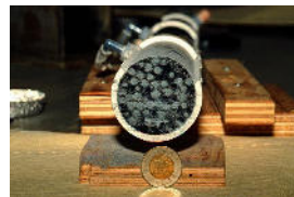
Drene granular colmatado en laboratorio (Rowe et al. 2000)
